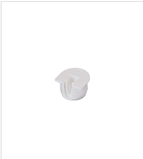
Ferrure d'assemblage VB 135 La ferrure d'assemblage VB 135 est à enfoncer dans un trou de diamètre de 20mm. Le fond peut être installé par le dessus. Le fond et la ferrure d'assemblage sont ensuite enfoncés sur le goujon. La forme conique du logement permet de serrer la tablette et de l'assurer contre tout décrochement. Utilisable pour des fond d'une épaisseur à partir de 16mm !
