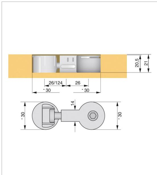
Installation rapide grâce au serrage par clé 6 pans de SW6.
