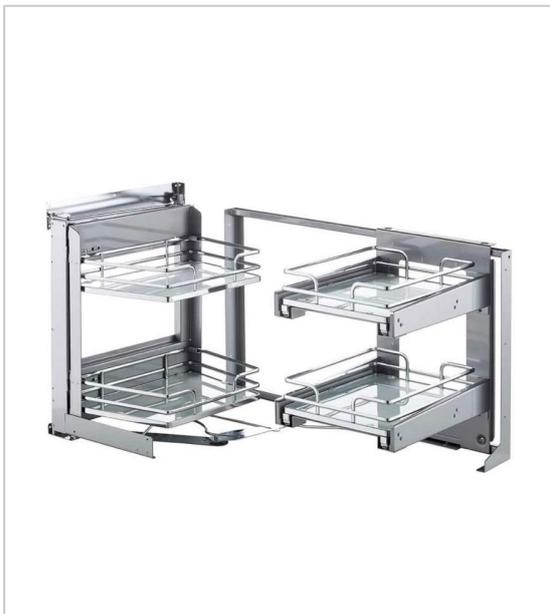
L'ouverture de la porte entraîne l'extraction du cadre pivotant, faisant ainsi coulisser face à l'ouverture les corbeilles situées dans l'angle mort du meuble, permettant ensuite de les extraire vers l'extérieur.
