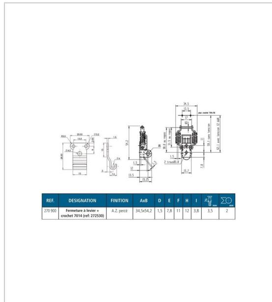
Fermeture à levier 7019 livrée avec crochet 7014.50 (compatible avec crochets 7010.50)
