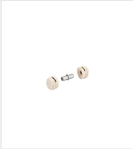
Cette ferrure d'assemblage discrete se compose uniquement d'un goujon fileté et d'un manchon à enfoncer muni d'une rondelle d'acier à ressort. Il est ainsi aisé d'assembler de manière fiable des composants en appuyant simplement. Un nain particulièrement puissant, car de nombreux tests ont mis en évidence une résistance à l'arrachement de 800N / 80kg. Qté 200 = 400 Everfix + 200 Duplo
