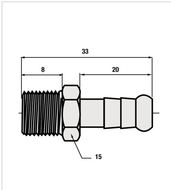
Raccord cannelé en laiton nickelé.
