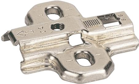
Plaque de montage en croix à visser à trous oblongs diamètre 5,4 mm pour réglage de hauteurFixation avec vis à tête fraîchement fraîcheuse diamètre 4,5 mm
