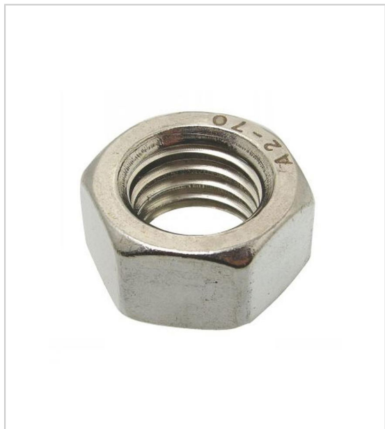
Ecrou hexagonal HU DIN 934 en INOX A2.
