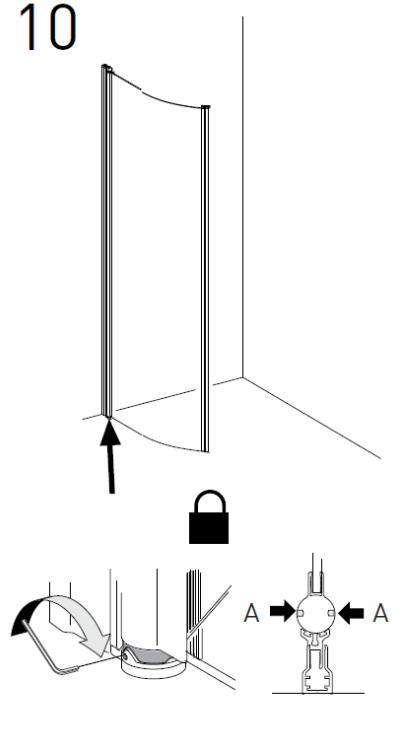
La position de fermeture de la porte est déterminée par la rondelle de positionnement.
