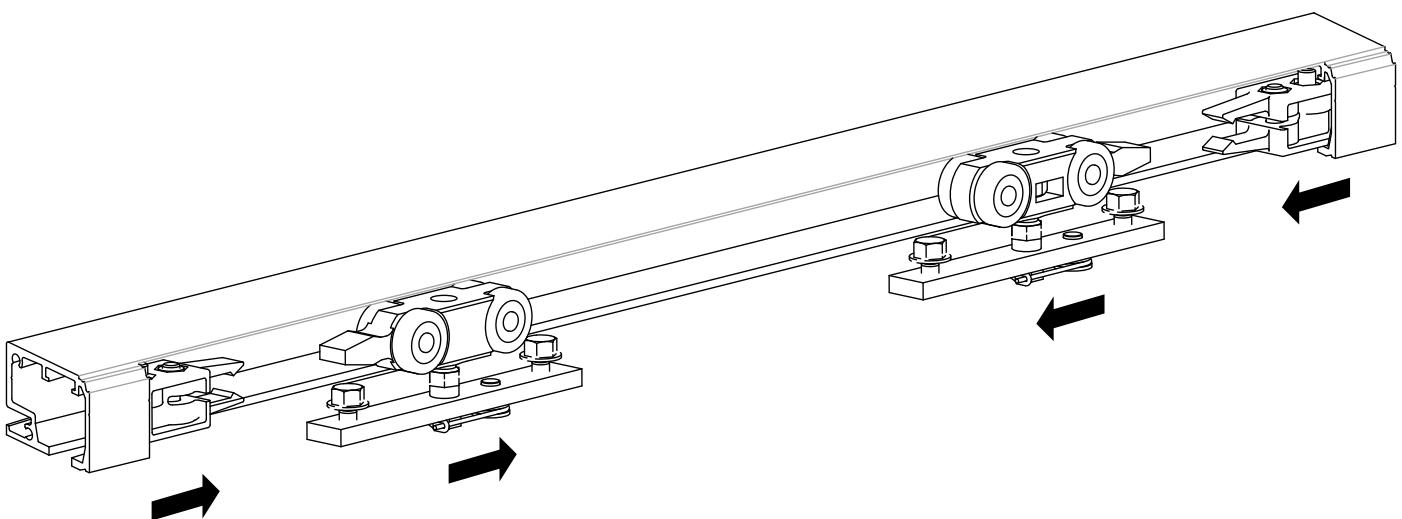
Monteer het compactprofiel 110.828.xxx in de deurvleugel. Laat aan elke kant 4 mm ruimte, zodat later de rubberen afsluitstukken kunnen worden geplaatst. Monteer, indien nodig, de vloergeleiderrail (optioneel).
