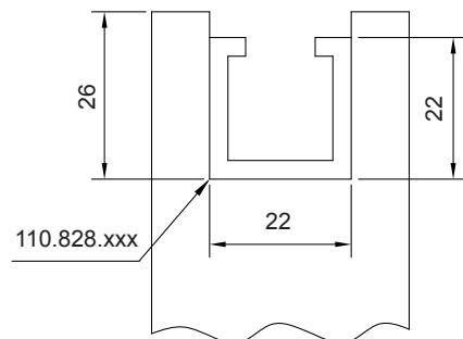
Schuif de compactblok voor de loopwieljes in het compactprofiel en bevestig deze met een steeksleutel.
