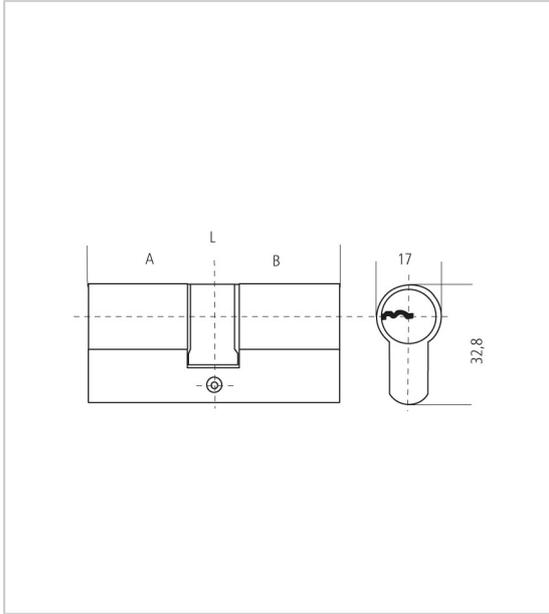
Cylindre laiton nickelé 16 pistons Haute sécurité
