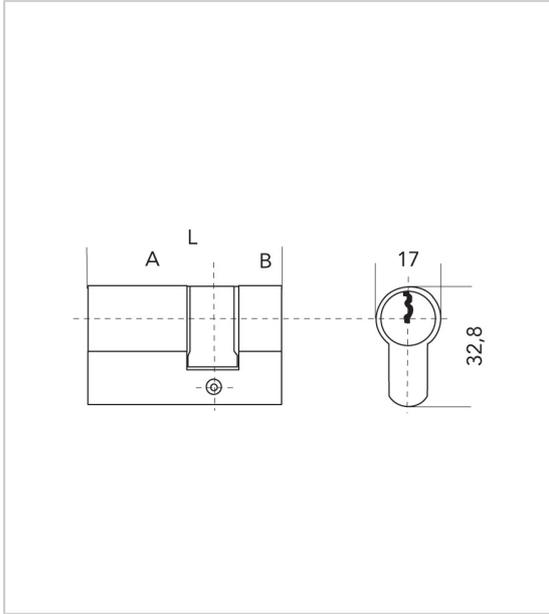
Cylindre laiton nickelé 16 pistons Haute sécurité
