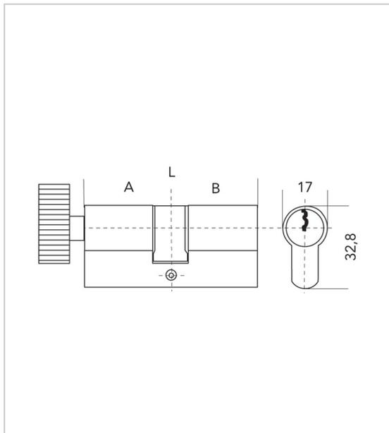
Cylindre laiton nickelé 16 pistons Haute sécurité
