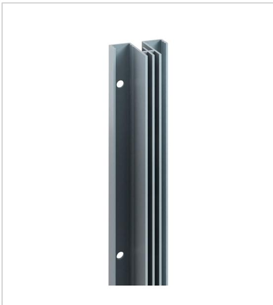
Crémaillère double perforation fine et discrète au pas de 37mm, pour l'habillage de panneaux d'épaisseur 19 mm sans recours au placage des chants.
