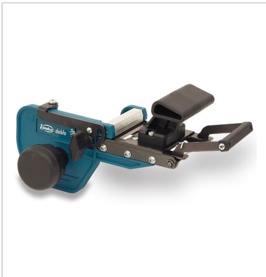
Appareil pour la coupe des excédents de chants aux deux extrémités des panneaux droits et de l'excédent des panneaux circulaires. La qualité du travail évite tout dommage sur le panneau ou le chant. Coupe des chants jusqu'à 55 mm de largeur et 1 mm d'épaisseur ou 25 mm de largeur et 3 mm d'épaisseur. Le système à guillotine permet une coupe parfaite avec le moindre effort, même sur des chants épais. Permet la coupe jusqu'à des angles de 60°.
