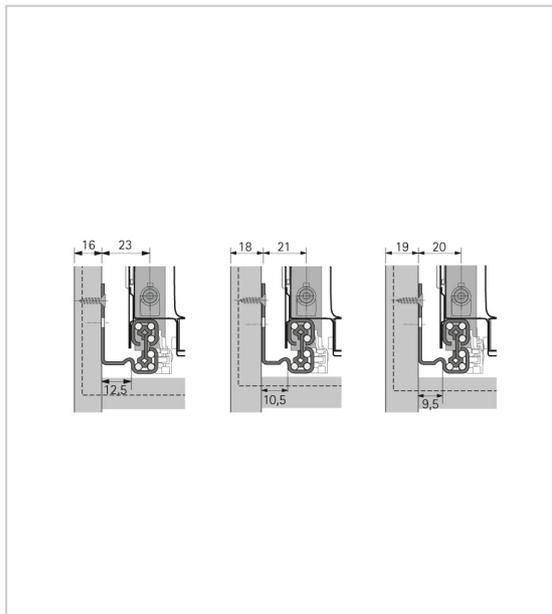
Dispositif avec amortisseur intégré permettant la fermeture du tiroir en douceur et sans bruit.
