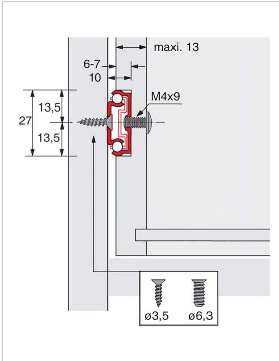
Coulisse de précision à sortie partielle avec butée de sortie et dispositif de blocage.
