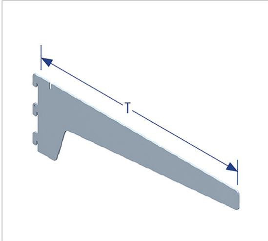
Console droite à 3 crochets pour fixation sur montants de gondoles à perforation au pas de 50mm.
