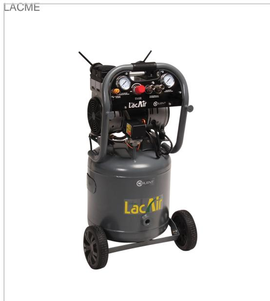
Compresseur monobloc insonorisé bicylindre mono-étagé à pistons oscillant : cylindres latéraux, à vitesse lente
