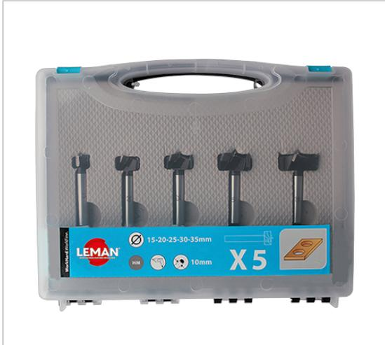
Coffret bois 5 mèches à percer carbure avec pointe de centrage, 2 coupes dégageuses, 2 traçoirs de queue : 10 mm.
