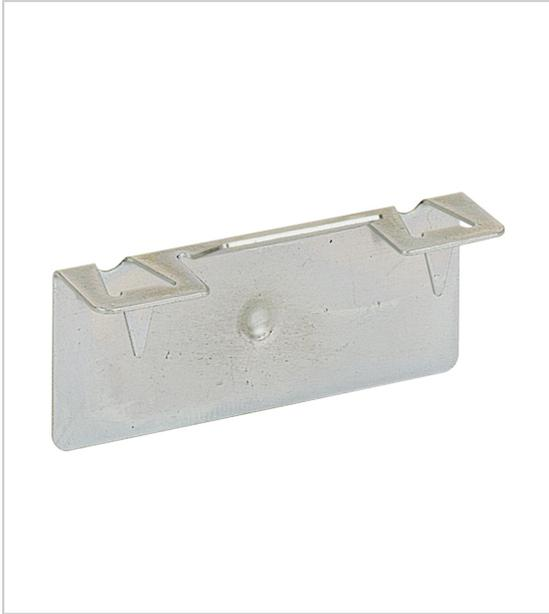
Utilisé pour pose de plinthe rarement démontée (plinthe latérale par exemple).
