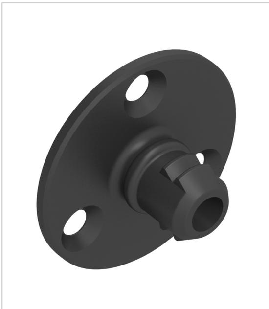
Clip très haute tenue avec une charge de retrait de 15kg et une résistance élevée au cisaillement (100kg). Il est conçu **pour le montage de panneaux de plafond ou muraux lourds.**
