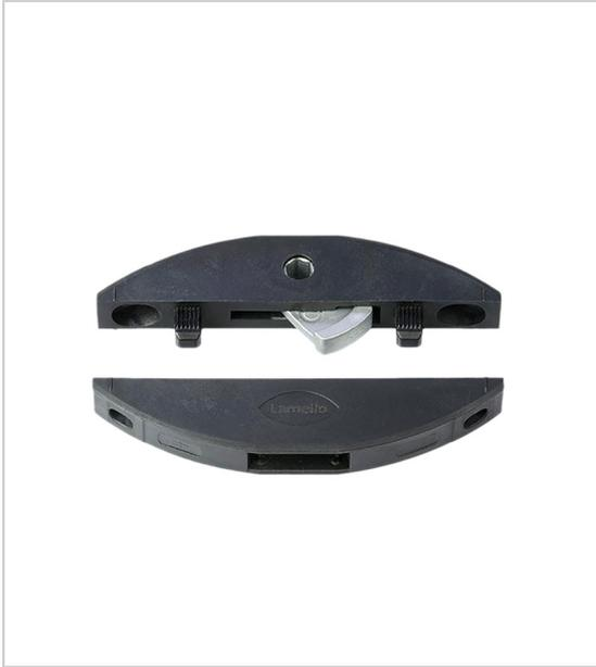
Clamex S-18 est un élément d'assemblage démontable qui se visse dans une rainure de 8mm de large. Grâce au trou d'accès minimaliste de 6mm, Clamex S-18 s'assemble et se désassemble à l'aide d'un levier.
