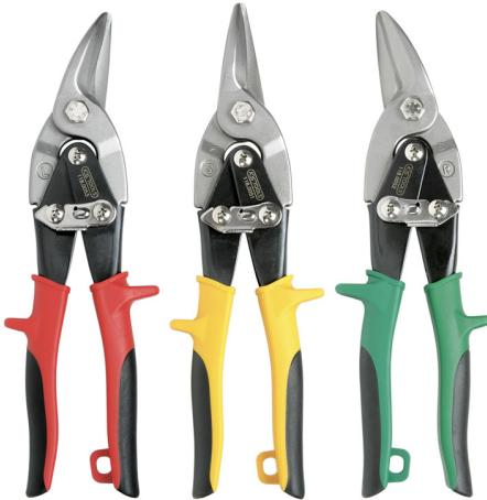
Ouverture automatique arrêt de verrouillage munie d'un trou d'accrochage lame durcie par induction poignée bi-matière coupe des tôles en acier jusqu'à Ø 1,25 mm coupe des tôles en acier inoxydable jusqu'à Ø 0,7 mm sens de coupe : 1 x à droite, 1 x droite; 1 x à gauche.
