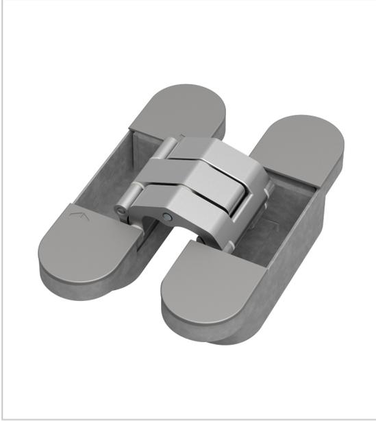
Charnière invisible TYO avec **une profondeur d'encastrement minimale de 21mm dans l'encadrement (29mm côté porte), permettant l'utilisation d'encadrements étroits** tout en conservant son aspect invisible.
