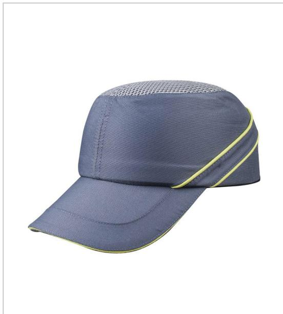
Casquette anti-heurt type base-ball, en textile polyester/enduit polyuréthane très aérée, partie supérieur en maille mesh, équipée d'une coque interne en polyéthylène et d'une mousse confort en EVA pour amortir les chocs
