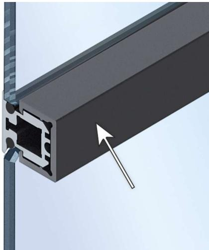
Profilé pour assembler deux éléments vitrés de 4 mm (verre de sécurité trempé) sur un plan, à la verticale ou à l'horizontale
