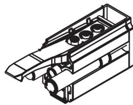
Butée SoftStop (amortie) avec ressort de blocage.
