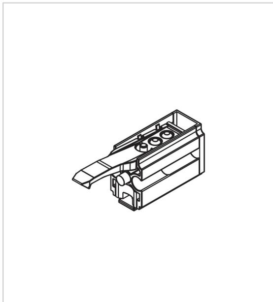
Butée de rail avec ressort de blocage réglable.
