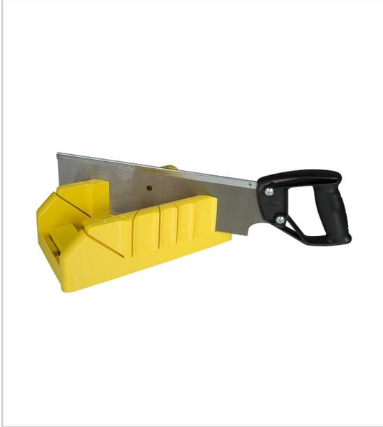
Boîte à onglets plastique 350 x 95 x 143 mm corps en ABSystème de rangement de la scie incorporé 3 angles de coupe 45°, 90° et 22,5 ° fournie avec une scie à dos.
