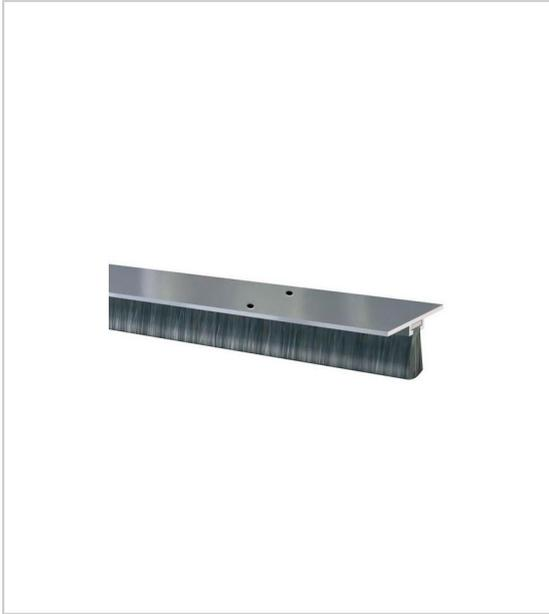
Support en aluminium naturel et une brosse souple en polypropylène imperméable pose en applique sous les portes et les coulissants écart entre la porte et le seuil compris entre 8 et 13 mm largeur : 27 mm prépercé.
