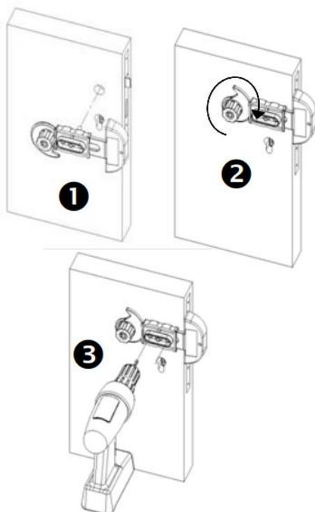
❶ Introduire l'axe du gabarit dans le fouillot de serrure puis le plaquer sur la porte.
