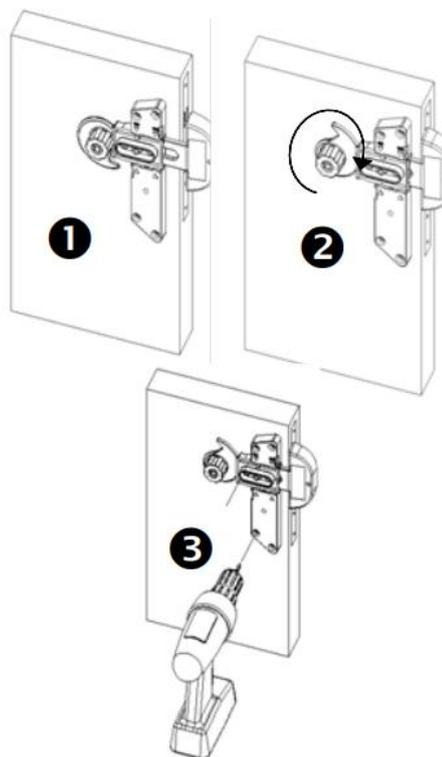
❶ Après clipage de la plaque repère A sur le gabarit suivant l'entraxe choisi 165 ou 195, introduire l'axe du gabarit dans le fouillot de serrure puis le plaquer sur la porte.
