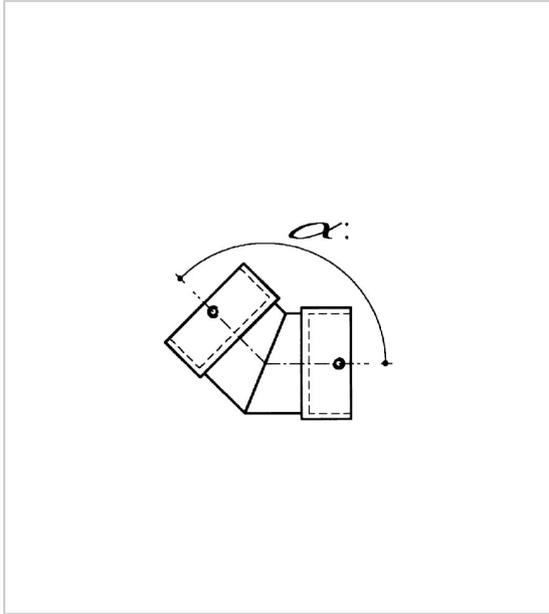
Angle sur mesure 90° à 175°. Pour tube Ø40.
