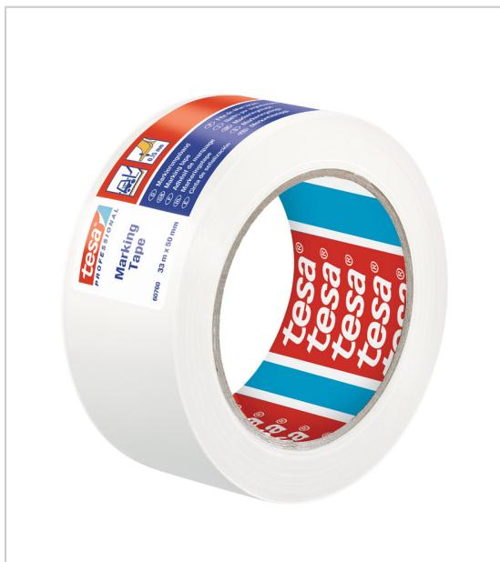
Adhésif en PVC plastifié résistant avec une masse adhésive en caoutchouc permet une adhésion sur un grand nombre de surface pour délimiter des zones de travail, zones dangereuses, zones de sécurité, ... déchirable à la main pour un marquage permanent ou temporaire épaisseur totale : 150 µm pouvoir adhésif sur acier : 2,5 N/cm allongement à la rupture : 160 % résistance à la rupture : 28 N/cm.
