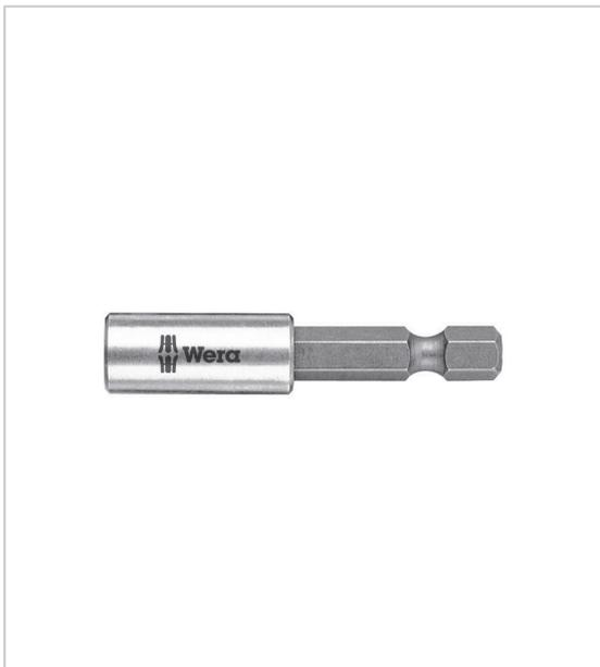
Avec double acier inoxydable et puissant aimant pour un maintien précis de l'embout convient aux embouts à emmanchement hexagonal 1/4" selon DIN 3126-C 6,3 (ISO 1173) et de la série 1 Wera. Conforme à la norme DIN 3126 (CE) - ISO 1173.
